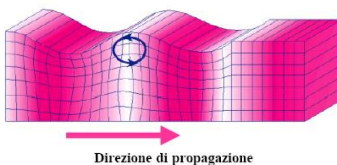
Fig. 4 – Schema di propagazione delle onde superficiali di Rayleigh.
