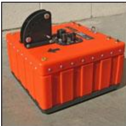
Fig. 3: Antenna radar da 400MHz utilizzata nel rilievo GPR.
